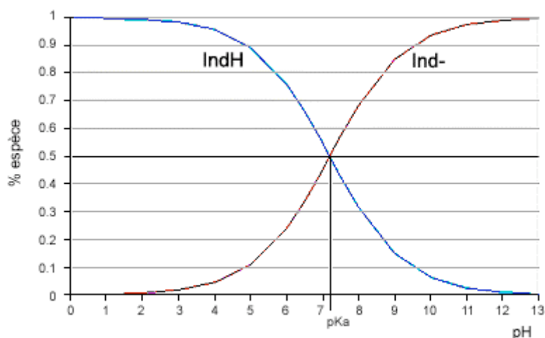
Fig. 1 : Diagramme de prédominance des espèces acides (IndH) et basiques (Ind-) du BBT, en fonction du pH.
